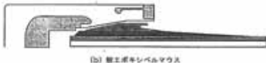
図9 エポキシベルマウス構造 Press units of rubber stress cone
